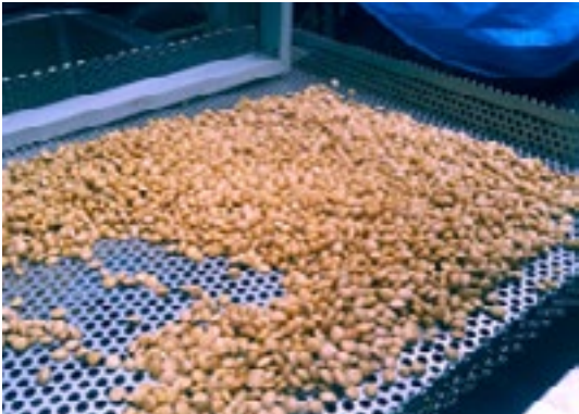
Figura 55: Equipo de vibración para separar piedras e impurezas
