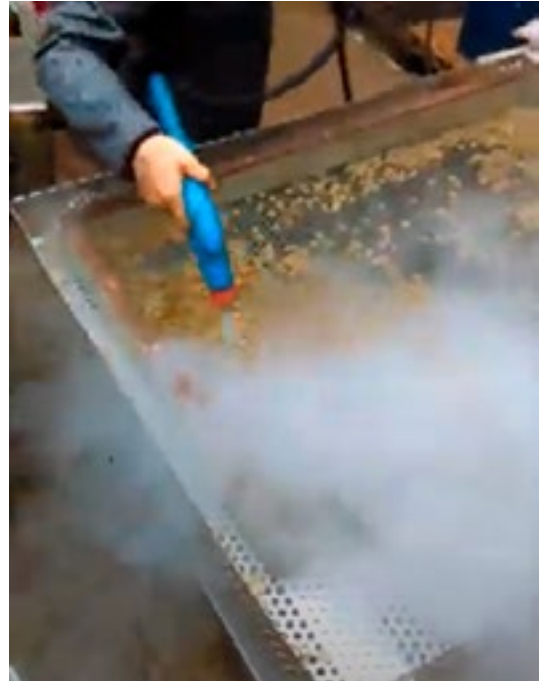
Figura 37: Uso de vapor en la limpieza de superficies en contacto directo con el producto
