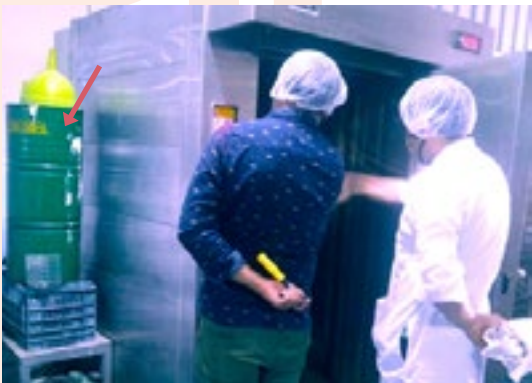
Figura 61: Peligro químico por presencia de combustible en sala de procesos
