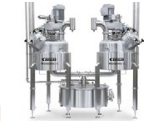
Figura 27: Equipo elevado del piso, dejando con suficiente espacio para la inspección, limpieza y control de plagas
