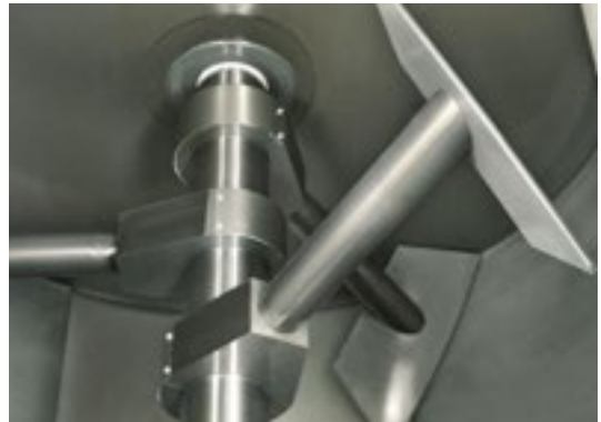
Figura 57: Equipos con riesgo de contacto metal-metal
